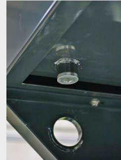
Drenaje del depósito de combustible
