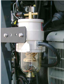
Filtro de combustible adicional con separador de humedad
