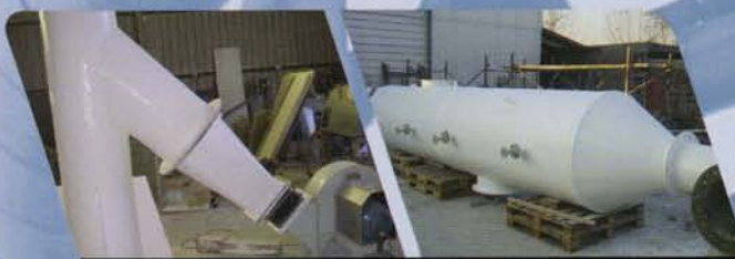
Fabricación de Scrubbers FRP (Proyecto Franke Minera Centenario (FLSMITH Minerals)
