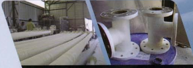
Fabricación Piping y Fittings en FRP Planta Molibdeno SPPC CODELCO Andina.
