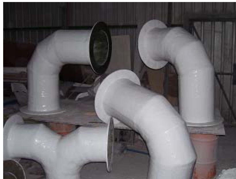
Ductos 300mm, 400mm y 450mm de conducción de gases
