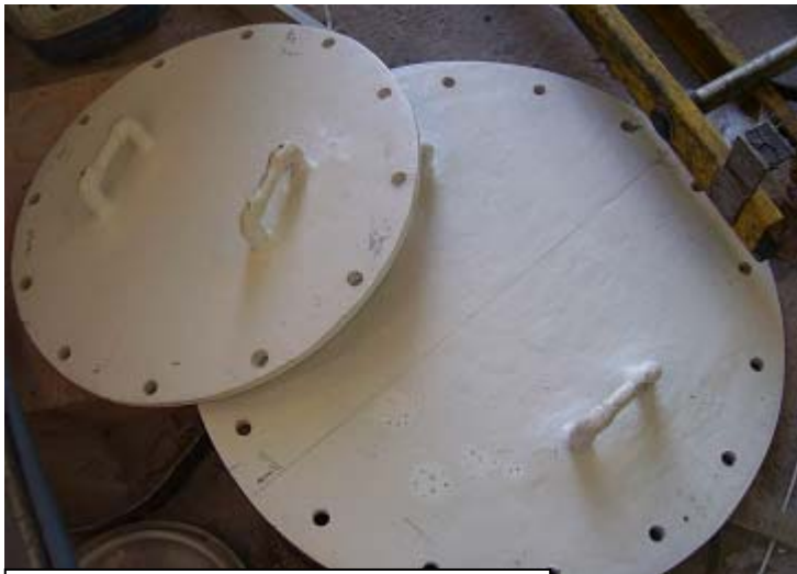
Tapas manhole y entrada gases
