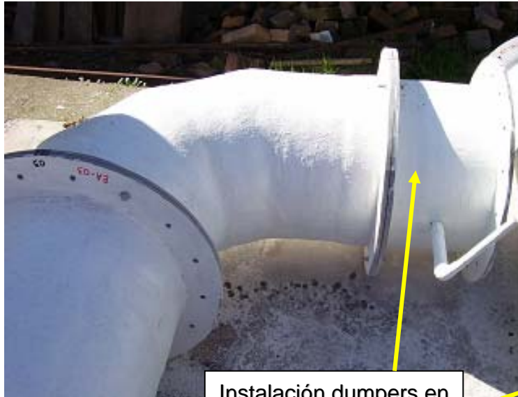
Instalación dumpers en circuito de gases
