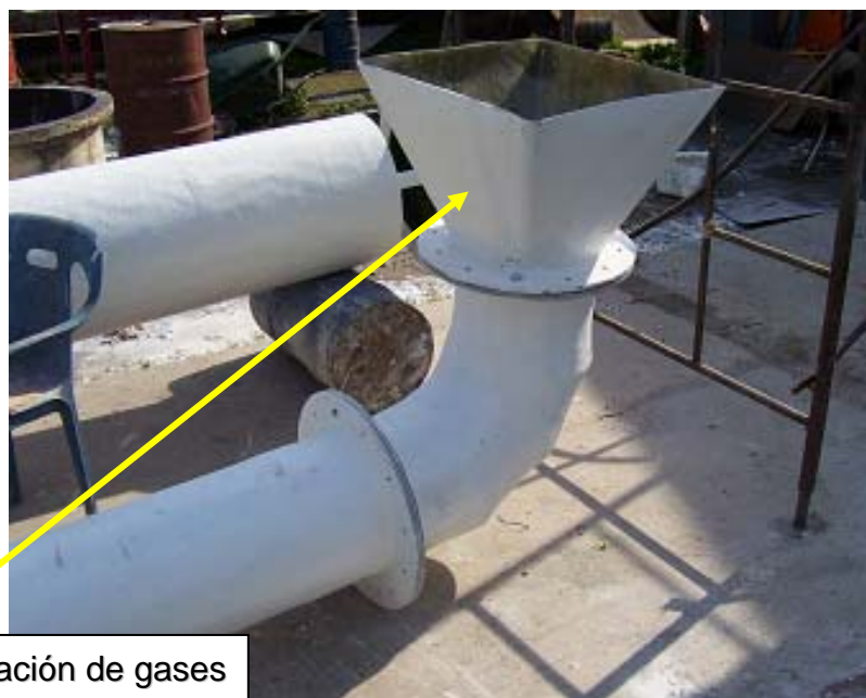
Derivación especial de conducción de gases
