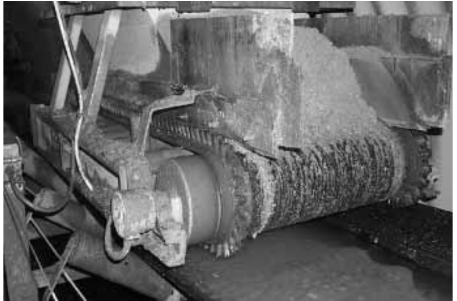
Dragadora marina trabajando en un ambiente mojado, salino y agresivo. Una estanqueidad IP67 - ES IMPRESCINDIBLE - a menudo con retenes reengrasables.
